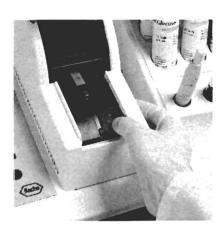
Si la cámara de medición está vacía, empujar la palanca de desbloqueo hacia arriba. Cerrar la tapa de la cámara de medición.
