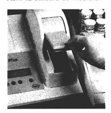
Para la limpieza se abre la tapa de la cámara de medición.
