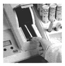
Introducir el Reflotron Check con la cinta magnética parda dirigida hacia arriba y la zona gris hacia el aparato.
