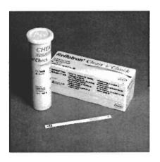
El Reflotron Check es una tira de control con una zona gris definida. Sirve para el control de la función del sistema óptico del Reflotron Plus.
