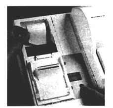
Cortar o doblar en biés el extremo suelto del rollo de papel e introducirlo recto en la ranura prevista pulsando simultáneamente la tecla del avance del papel ①.
