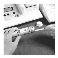
La Reflotron Pipette debe ser utilizada con puntas de alta calidad (p. ej. puntas de pipeta; Roche Diagnostics, REF 1 0140023).
