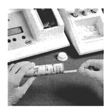
Retirar el Reflotron Check del tubo y fijarlo en el soporte para portarreactivos.
