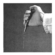
Después de la aplicación de la muestra se puede expulsar el tubo capilar apretando el botón hasta el segundo tope.
