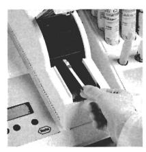
15.05.01 09:13:04 GLU 128.0 mg/dl El resultado de la medición permanece visualizado hasta que se abre la tapa de la cámara de medición.
