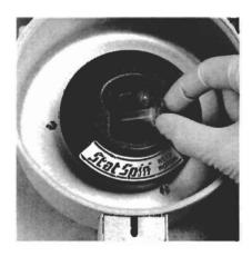
Para obtener el plasma se colocan el recipiente de colección y un recipiente de contrapeso en un rotor de la centrífuga adecuado para el recipiente de colección y se centrifuga. En caso necesario se utilizarán adaptadores adicionales para la centrífuga.
