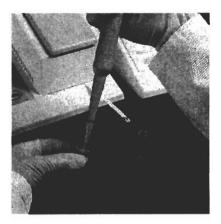
Una vez centrifugado, el plasma se utiliza inmediatamente para la determinación de la sustancia a analizar con el portarreactivos Reflotron, dosificándose la muestra directamente del sobrenadante con la Reflotron Pipette.
