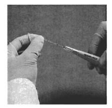
Insertar el tubo capilar con la **marca de color oscuro** hasta el tope en el aplicador.
